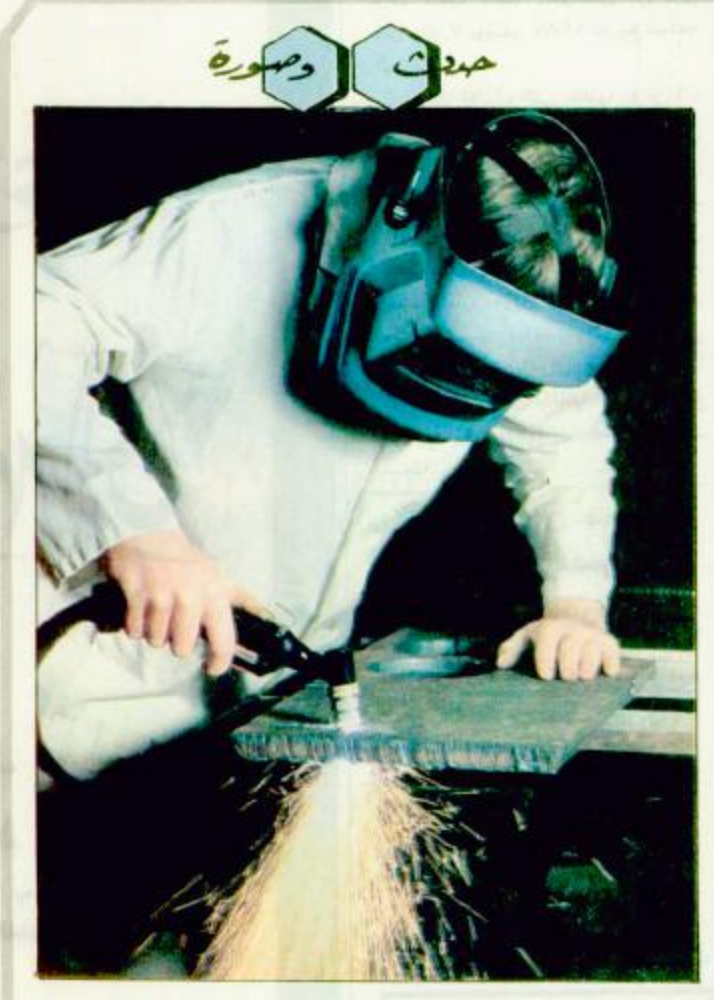
يفتتح سرعات عليا في القطع مع استعمال مصادر صغرى للطاقة سهلة النقل واخص في التشغيل.
